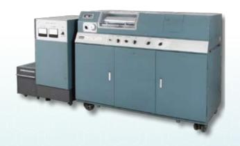
ちなみに旋光分散計の試作開発の過程で、光学活性物質・テストステロンのスペクトル測定に成功したのは、1961年7月のことであった。 本機は、応用光学研究所以来の"赤外の日本分光"に転機をもたらした。
