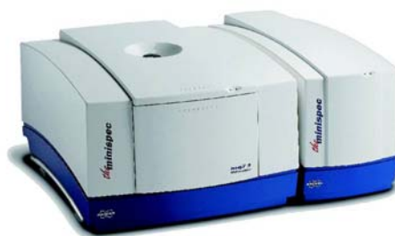
図 6 永久磁石型 NMR 装置
