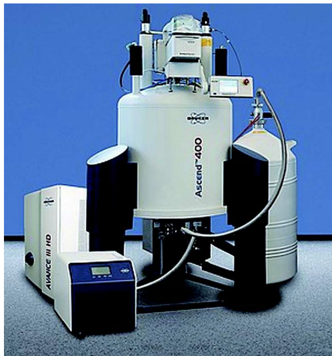
図 5 超伝導磁石型 NMR 装置
