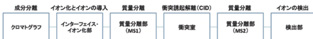
図1 トリプル四重極質量分析計の装置構成
