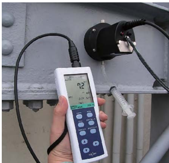
図11 表面塩分計の測定の様子
