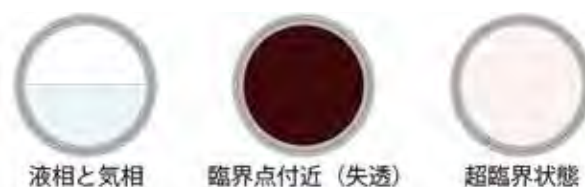
図2 液体から超臨界状態への状態変化
