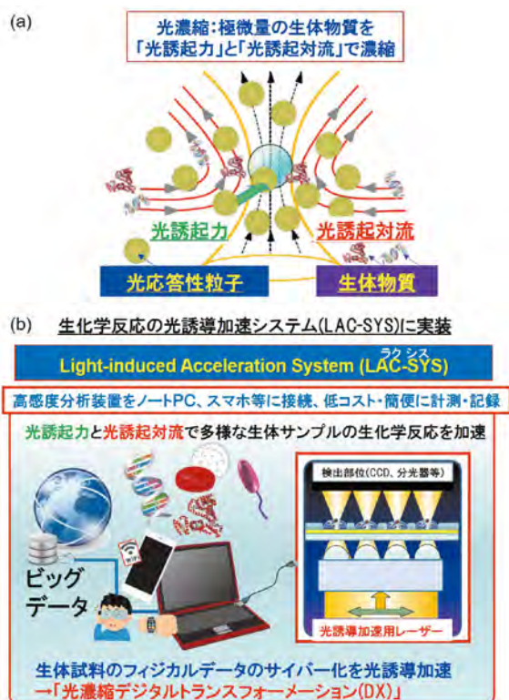
図2 (a) 光濃縮の基本原理。(b) 光濃縮を利用した生化学反応の光誘導加速システム(LAC-SYS)と次世代のバイオ分析DXプラットフォームのイメージ。
