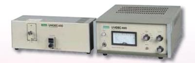
1973年、日本分光は高速液体クロマトグラフ専用検出器としては世界初の可変波長型紫外吸収分光光度計を完成させた。光源には重水素ランプ、分光器にはモンクギリーソン型モノクロメーターを採用、出射スリットと試料セルを一体化することでエネルギー効率を飛躍的に向上した。これらの工夫により、ノイズの除去とドリフトが低減、試料に対して最適な波長を選択できることから、当時ガスクロマトグラフに対して最大の欠点と指摘されていた液体クロマトグラフの高感度検出を実現した。この検出器は波長可変でありながらコンパクトで低価格、またセルはカセットテープにヒントを得てワンタッチ着脱式として操作性の向上を図った。
