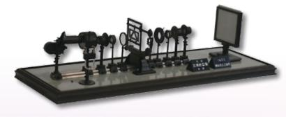
る。本装置は一般構造物や機器構造物等の荷重応力分布の解析や高分子材料の内部応力測定等に用いられるため、造船・航空・建築 土木・大型機械・大学・国立研究機関などの幅広い分野に普及し、多大な貢献をした。
