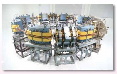
本装置は、電子蓄積リングであり、高エネルギー電子を一定のエネルギーで周回させるものである。加速器を周回する電子が出す電磁波 (放射光と呼ばれる)は、広いエネルギー領域をカバーする白色光であり、蓄積リングで一定のエネルギーの電子を利用することで、光スペクトルが一定となり、他に良い光源が存在しない真空紫外~軟X線領域で理想的な光源と考えられていた。完成後、真空紫外、軟X線領域での光物性研究に応用されるとともに、光電子分光用励起光源としても利用され、数々の発見を導いた。
