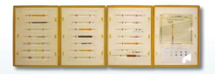
現在ではガラス管内径のコントロールにより、濃度目盛りを直接ガラス管に印刷して同様の精度が得られており、測定対象物質、濃度範囲も大きく広がっている。
