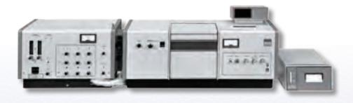
170-70形 日立偏光ゼーマン原子吸光分光光度計は試料を炭素炉内で加熱し、発生した原子蒸気の光吸収により $\mu g/L(ppb)$ レベルの金属類の濃度を測定する装置である。試料に磁場をかけて吸収線を分裂させることによりバックグラウンド補正を行う、ゼーマンバックグラウンド補正方式を採用した国内初のモデル。従来の重水素ランプバックグラウンド補正に比べて補正能力が優れており、当時公害問題にもなっていたカドミウム、ヒ素、鉛等の重金属汚染の測定に威力を発揮した。現在のゼーマン原子吸光光度計の先駆けとなった装置である。
