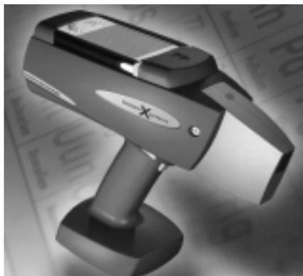
図3 - 3 - 5 ピistol型蛍光X線分析装置
