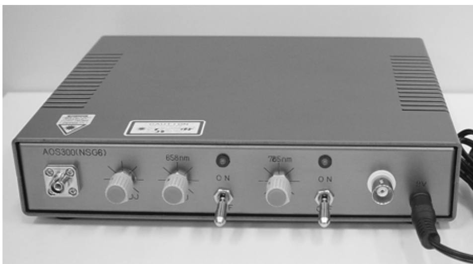
図 3 - 3 - 2 試作した光源 (箱) の外観写真 (箱の大きさ 100 × 140 × 40mm : 横 × 奥行き × 高さ)
