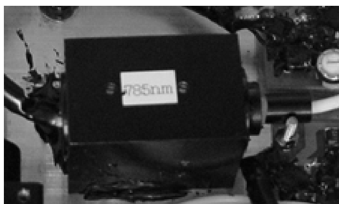
図 3 - 3 - 2 試作した光源 (箱) の外観写真 (箱の大きさ 100 × 140 × 40mm : 横 × 奥行き × 高さ)
